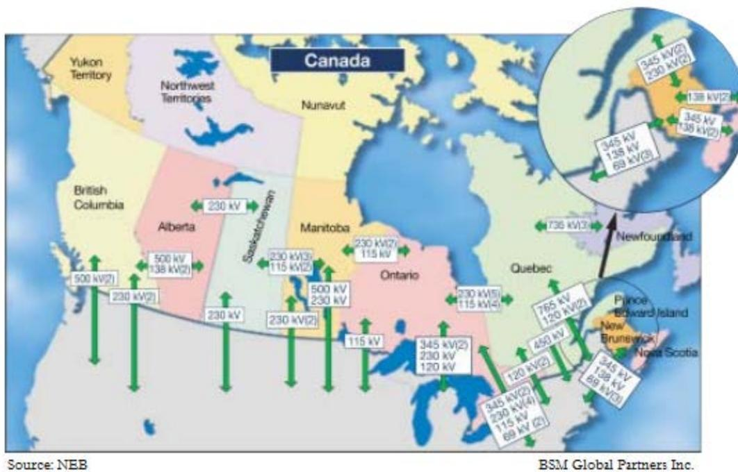
La rete di trasmissione nord-sud e l'integrazione del sistema gioca un importante ruolo nella modernizzazione della rete in Canada e negli Stati Uniti. Il sistema interconnesso permette una condivisione delle riserve (reserves) e un sistema di sicurezza comune per le cadute di
